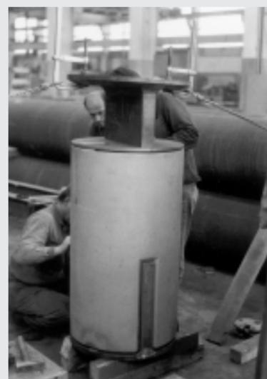
**Zugversuch an der Original-Bauteilprobe**
